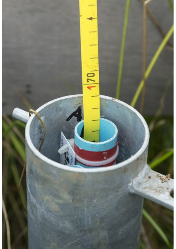
Peilbuis om de grondwaterstand te meten in het Mantingerbos en de Mantingerweiden (Drenthe).
