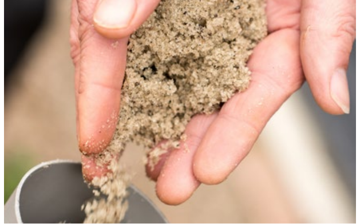
Struviet wordt gewonnen uit o.a. afvalwater en separaat ingezamelde urine.
